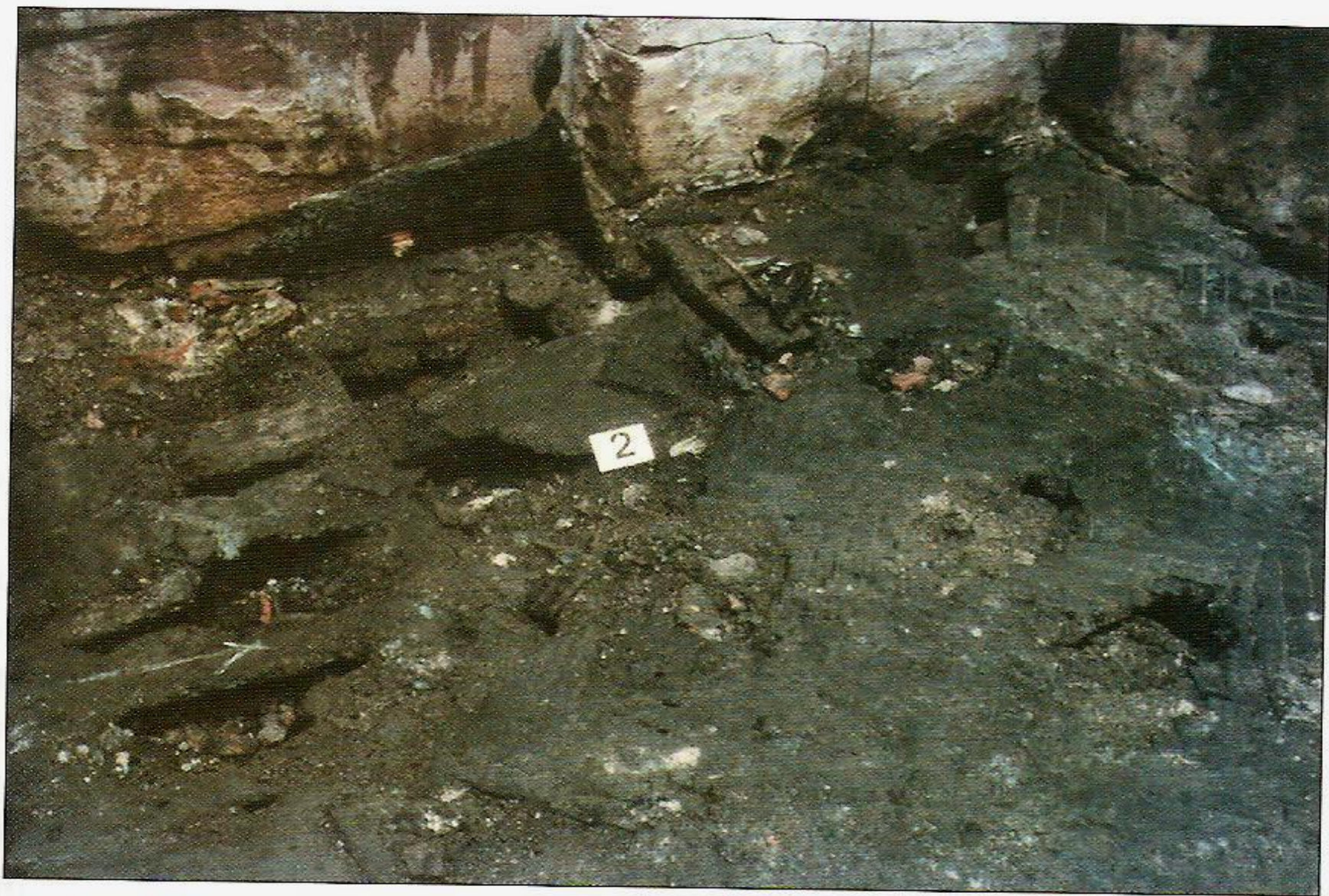
Slika 35. Po intenzitetu i orijentaciji opožarenosti drvenog poda moguće je odrediti smjer odakle se širila plamena fronta.
