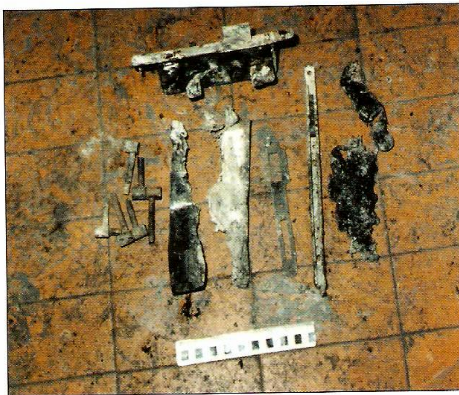
Slika 46. Prikaz termičkih oštećenja na bravama, nastalih kao posljedica djelovanja visokih temperatura požara
