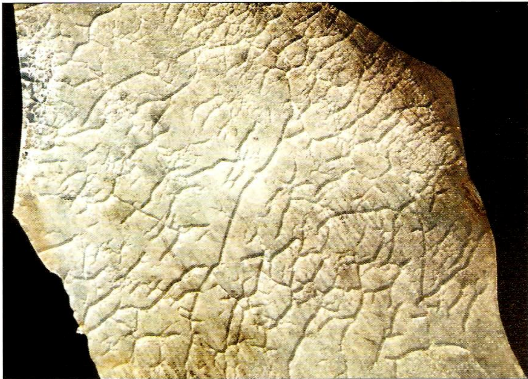
Slika 41. Prikaz fragmenta stakla intenzivno oštećenog toplotinom. Nema oštarih rubova.
