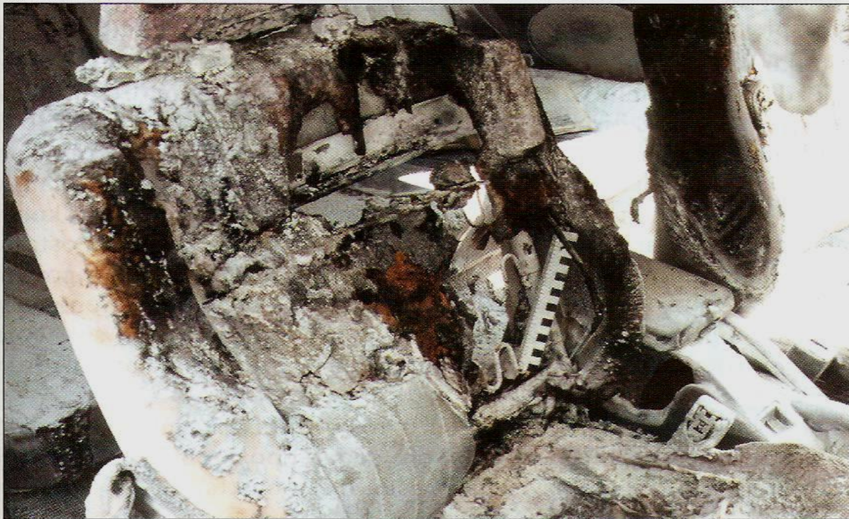
Slika 60. Prikaz vatrom oštećenog sjedala suvozača osobnog vozila. Radi se o požaru nastalom ubacivanjem zapaljenog komada kartona kroz poluotvoren prozor suvozačevih vrata.
