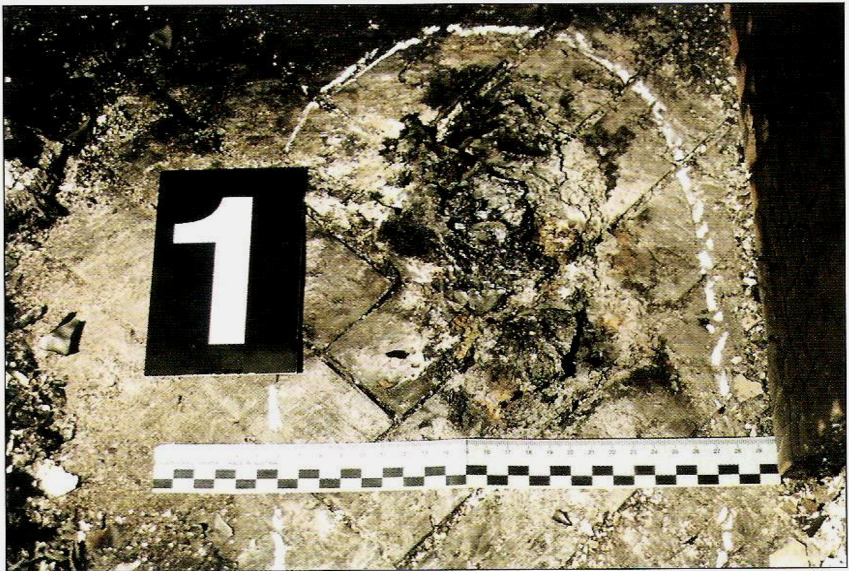
Slika 57. Prikaz vidljivih karboniziranih ostataka plastičnog koša za smeće, u kojem je došlo do pojave požara zbog odbacivanja neugašenog opuška cigarete. U košu se nalazio gorivi materijal (odbačeni papir, celofan i sl.).
