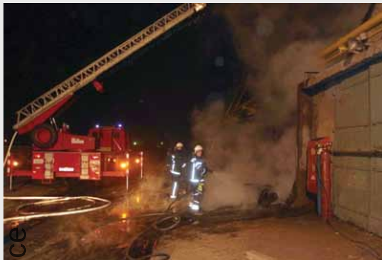
Korištenje autoljestve - navalna grupa uspostavlja mlaz s pjnom
